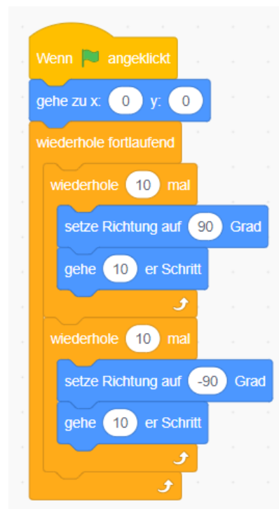
cugl element «wiederhole fortlaufend»
